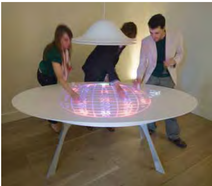
Dans le cadre de l'exposition «The Electric Kid Show» l'Allemand Moritz Waldemeyer présente des tables en Corian® dotées de surfaces tactiles interactives pour jeux: ce matériau laisse passer la lumière et réagit au toucher.
